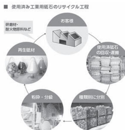
図5 使用済み工業用砥石のリサイクル工程
